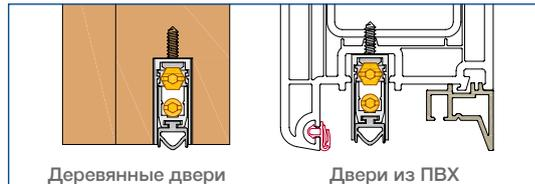
• **ХАРАКТЕРИСТИКИ** Механизм (ПАТЕНТ) параллельного опускания подвижного профиля с прокладкой, который имеет ДВОЙНУЮ РЕГУЛИРОВКУ (винт E: опускание – винт R: наклон) для сильного и равномерного прижима по всей длине.
